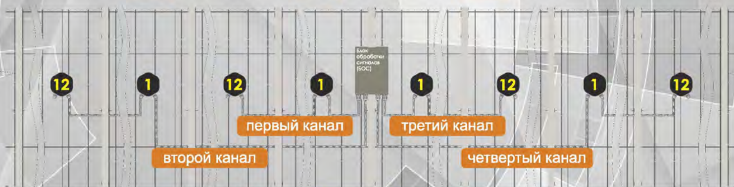
Вариант установки комплекса на сетчатое ограждение типа «Маха»
