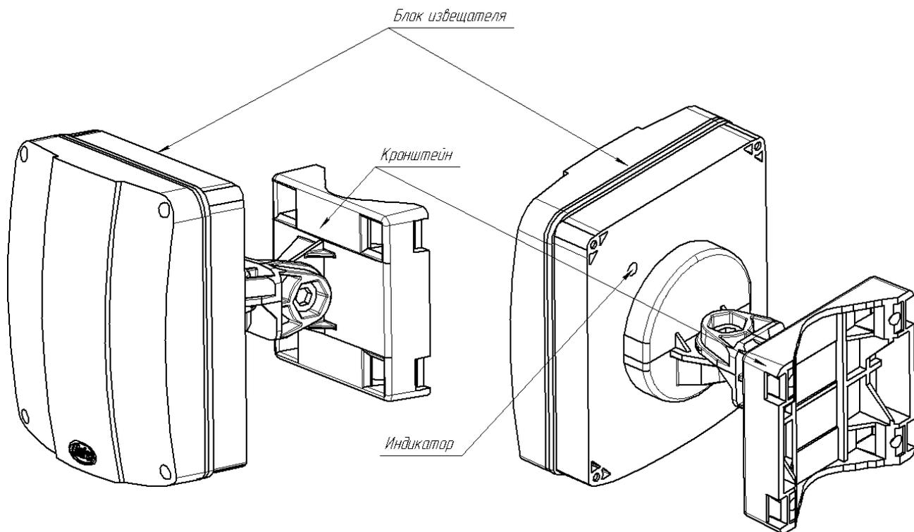
Рисунок 1.2 – Внешний вид блока извещателя
