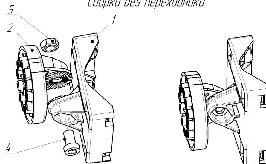
1 - Основание кронштейна, 2 - Кронштейн (деталь, закрепленная на блоке извещателя), 3 - Переходник 90°, 4 - Винт (2 шт.), 5 - гайка (2 шт.)
