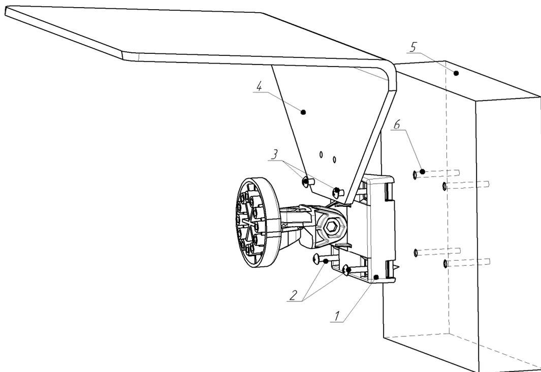
1 - Основание кронштейна, 2 - Шуруп 4x40 из состава КМЧ (2 шт.), 3- Шуруп 4x60 из состава КМЧ (2 шт.), 4 - Козырек, 5 - Плоская поверхность (стена), 6- Дюбель из состава КМЧ.
