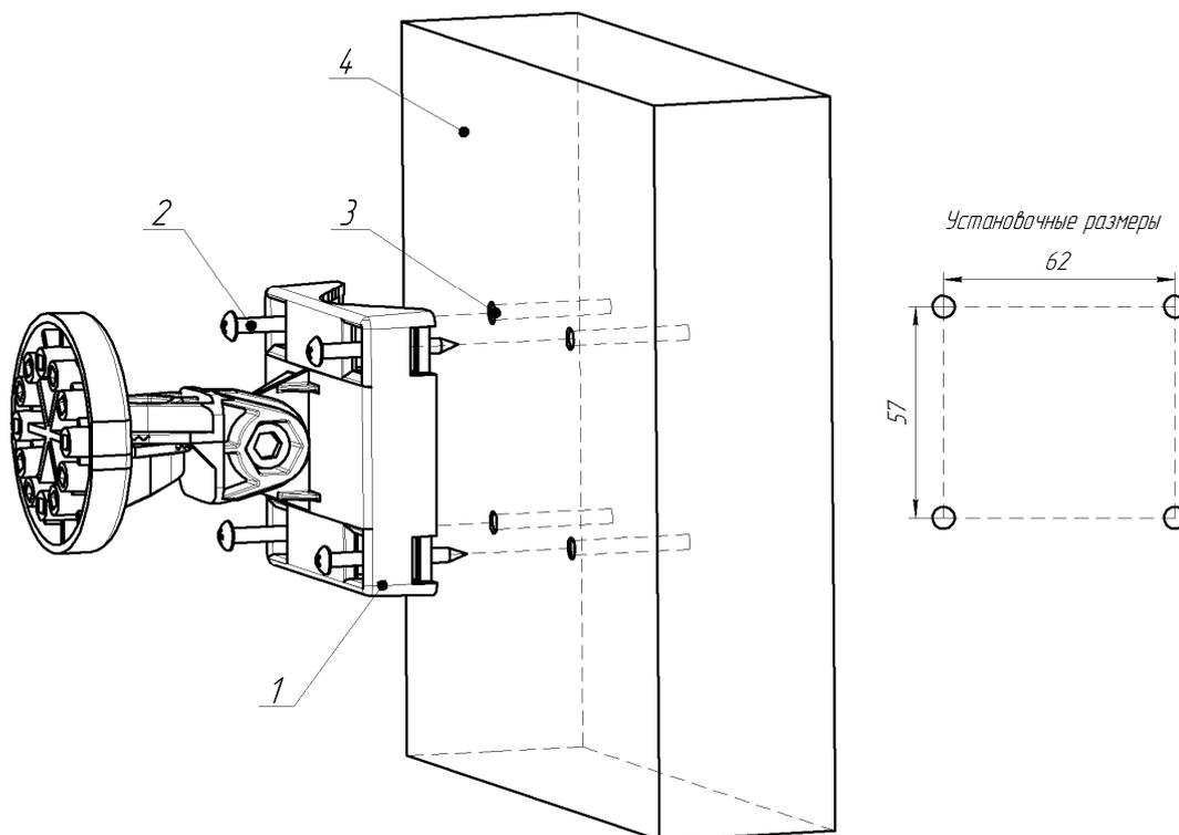
1 - Основание кронштейна, 2 - Шуруп из состава КМЧ, 3- Дюбель из состава КМЧ, 4 - плоская поверхность (стена)
