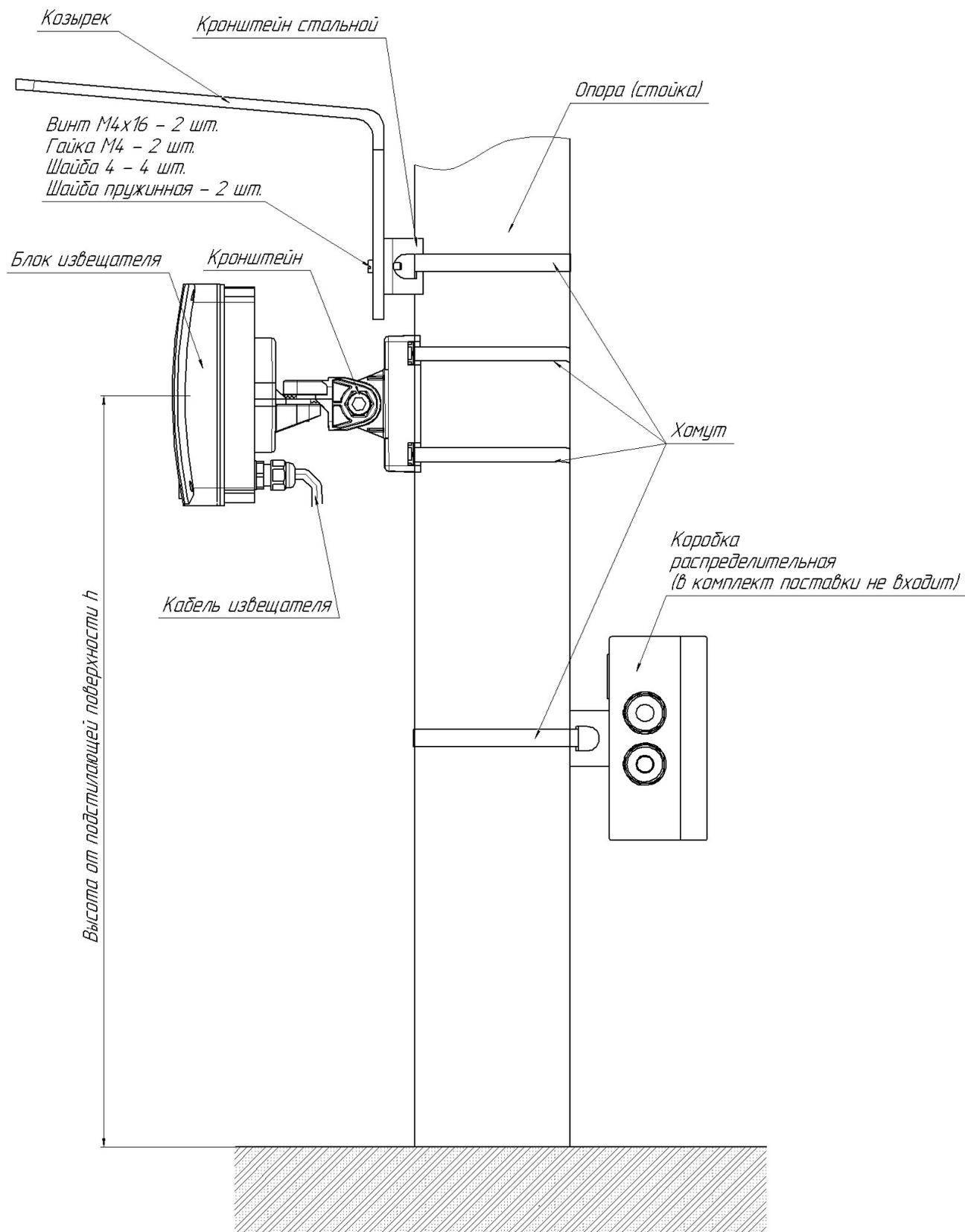
Рисунок 2.1 – Установка извещателя на опоре (высота установки  $h=1.2\dots1.5$  м)
