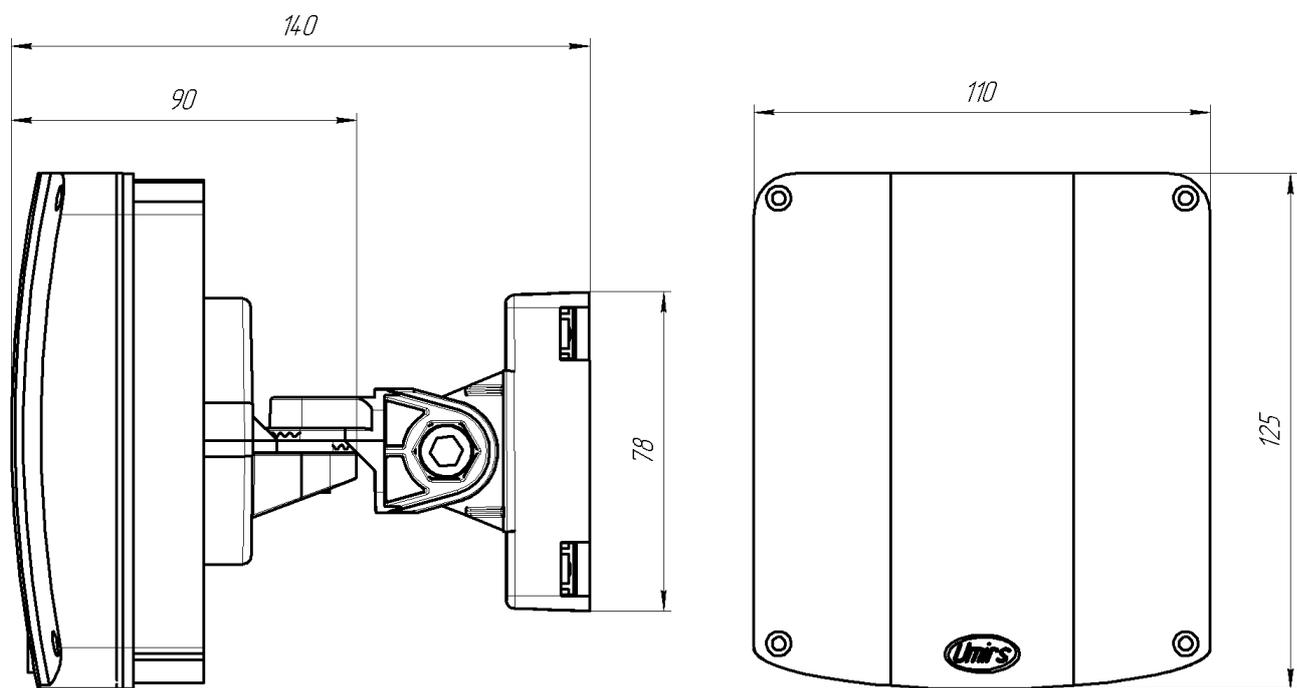
Рисунок 1.3 – Габаритные размеры блока извещателя
