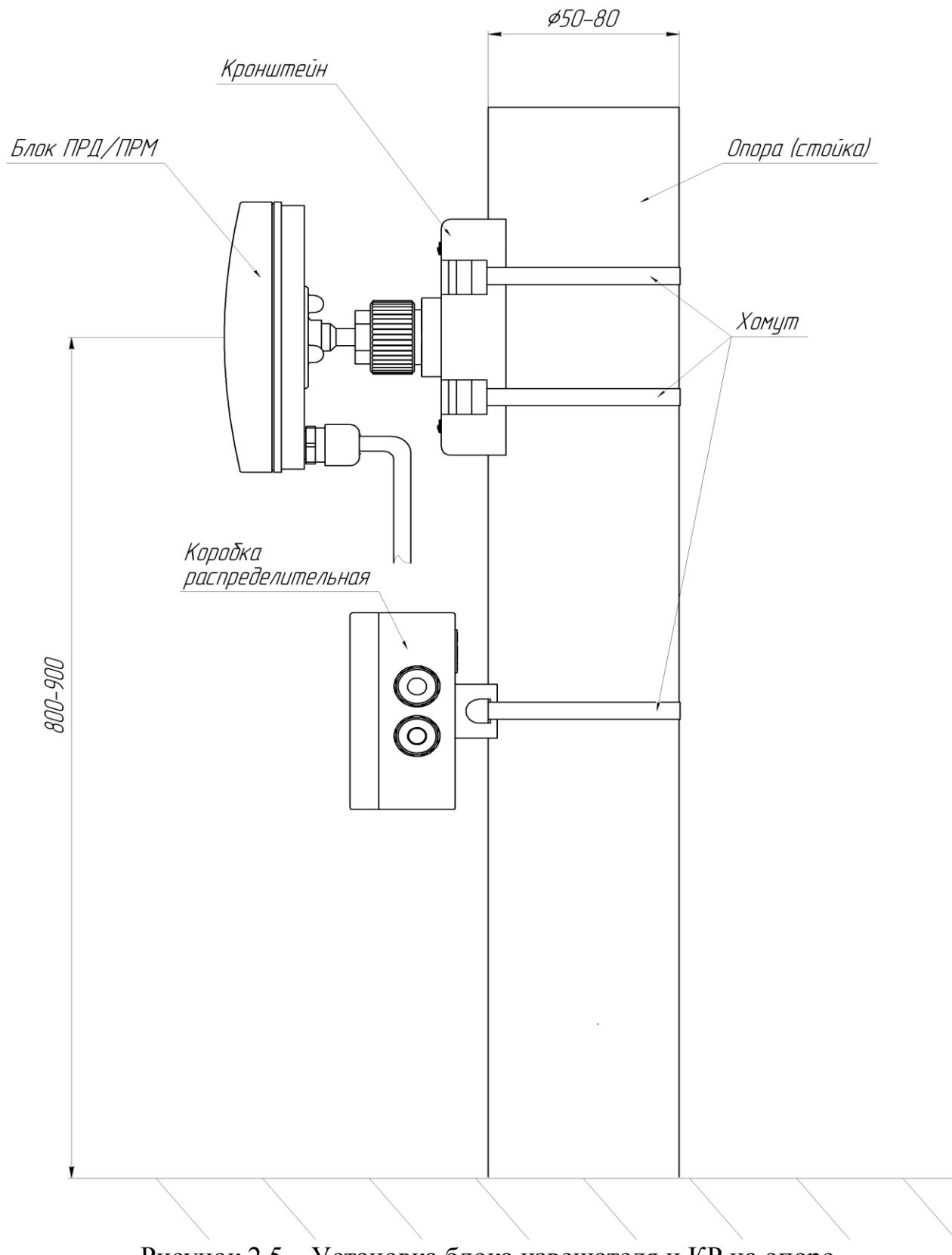
Рисунок 2.5 – Установка блока извещателя и КР на опоре.
