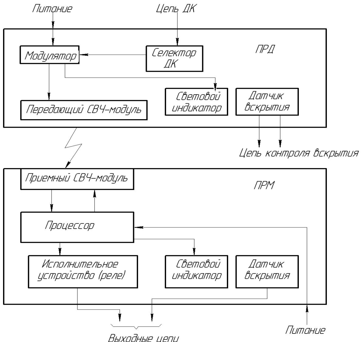
Рисунок 1.2 – Функциональная схема извещателя
