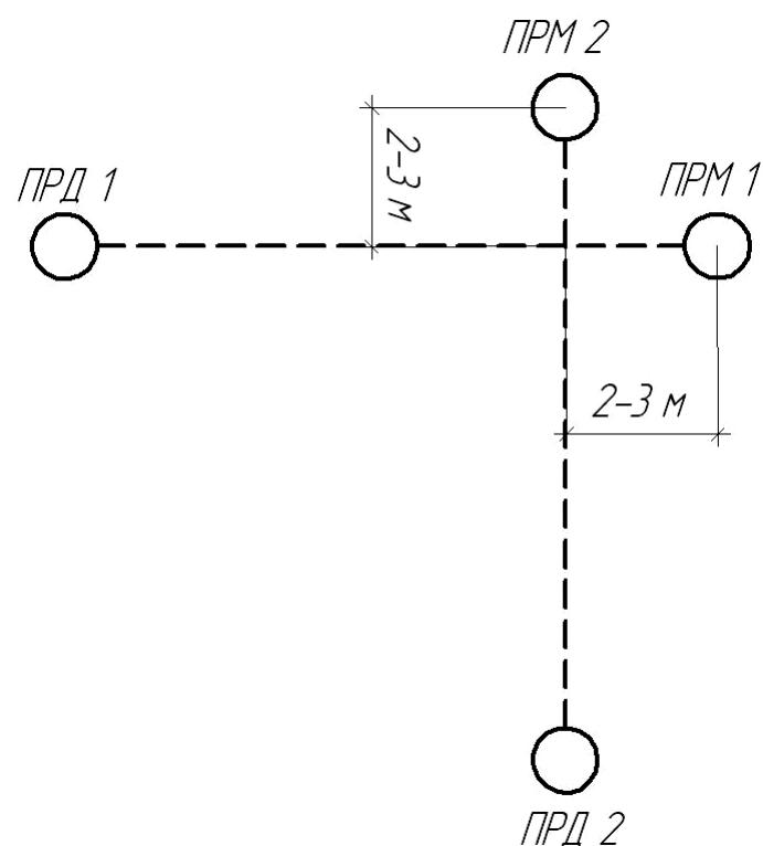
Рисунок 2.4 – Установка под углом 90° с перекрытием участков
