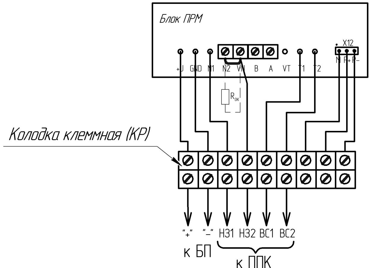
Рисунок 2.6 – Подключение ПРМ с раздельным выводом цепей реле (НЗ) и датчика вскрытия (ВС)
