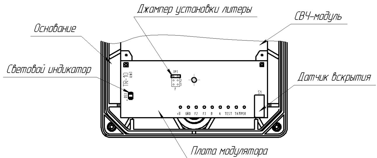
Рисунок 1.5 – Внешний вид ПРД со снятой крышкой
