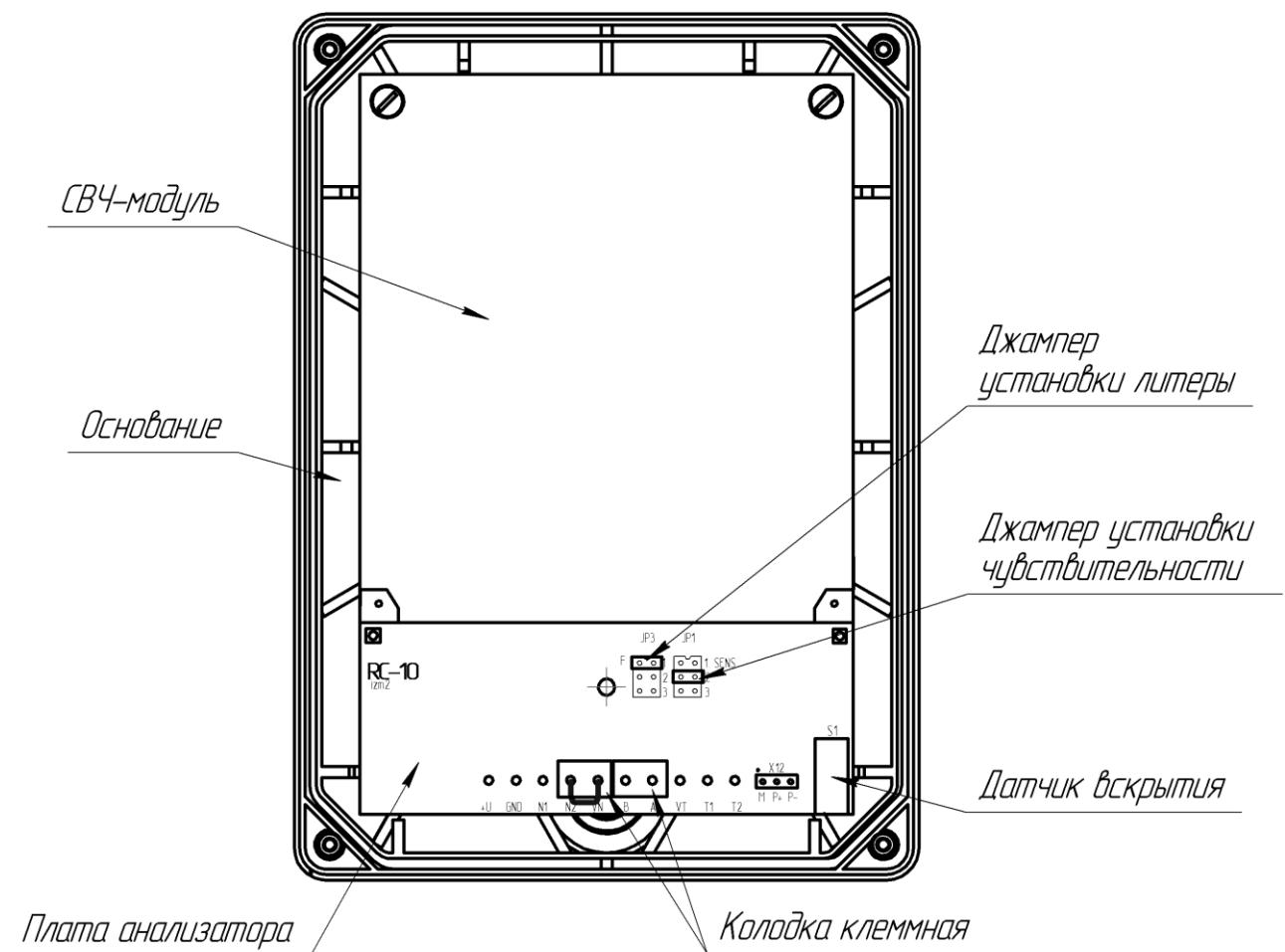
Рисунок 1.4 – Внешний вид блока ПРМ со снятой крышкой
