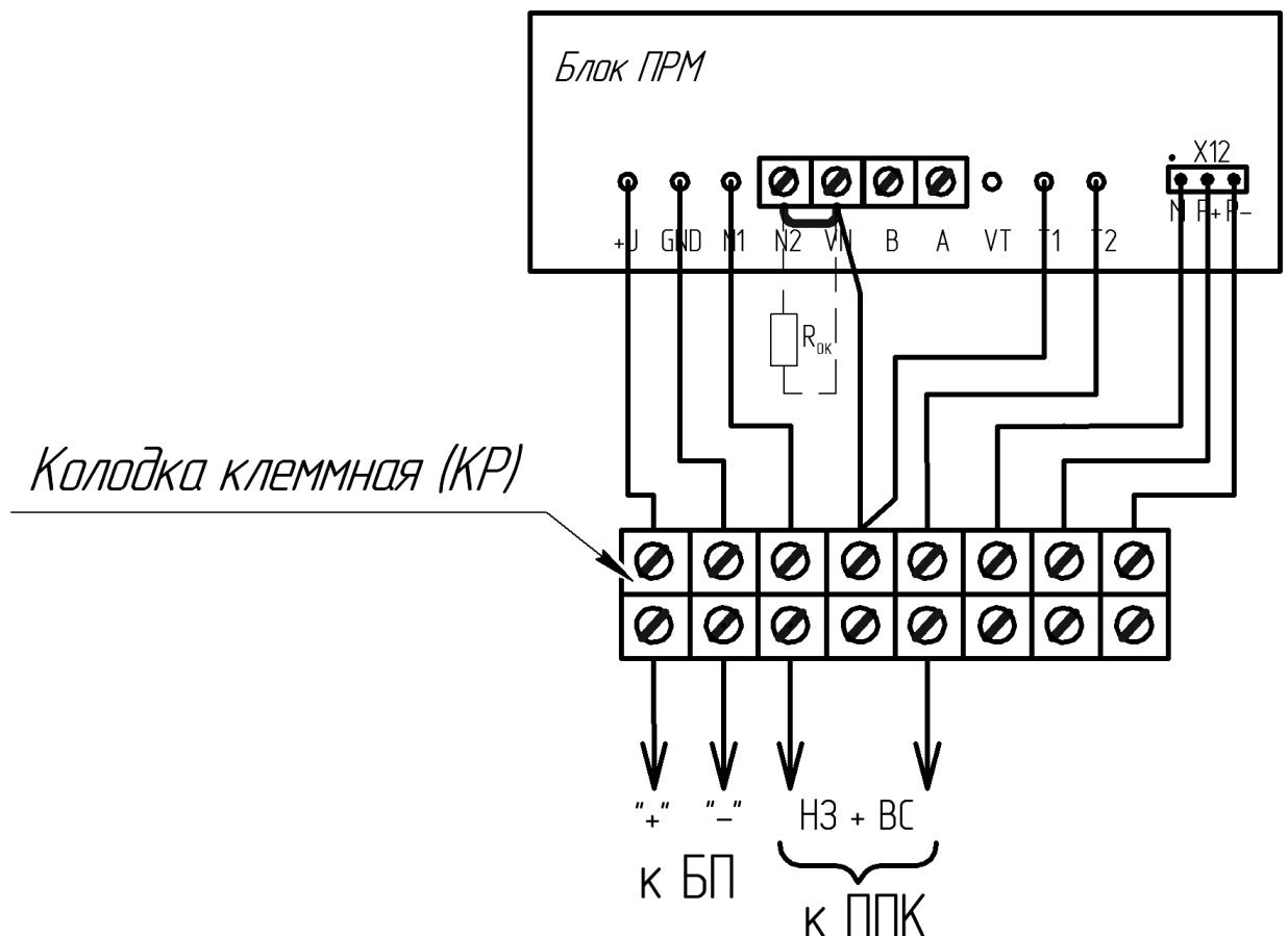
Рисунок 2.7 – Подключение ПРМ с объединением цепей
